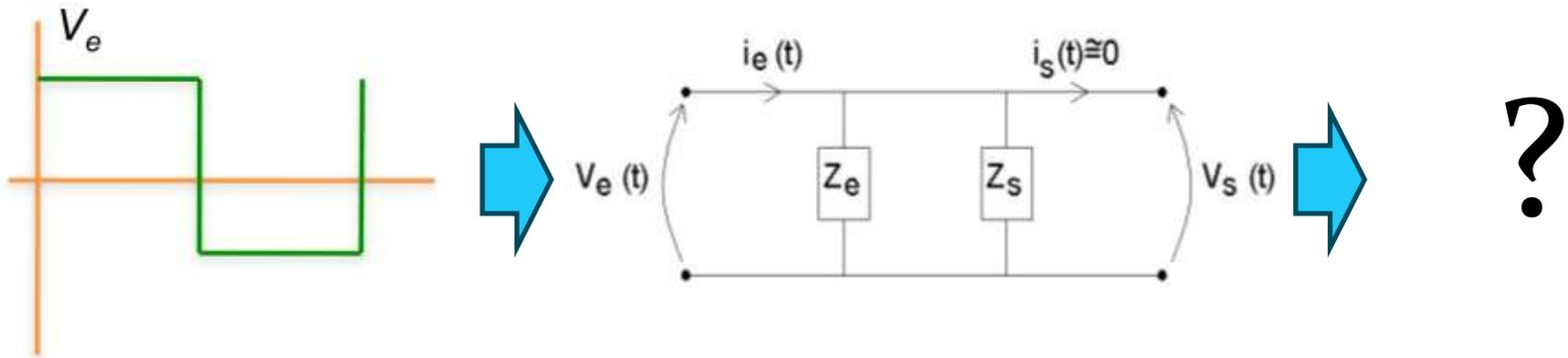
$$V_e = \begin{cases} \frac{4V_0}{\pi} \sin(\omega t) + \\ \frac{4V_0}{3\pi} \sin(3\omega t) + \\ \frac{4V_0}{5\pi} \sin(5\omega t) + \\ \dots \end{cases} \quad \Rightarrow \quad G(\omega) = \frac{1}{\sqrt{1 + (\omega/\omega_c)^2}} \quad \Rightarrow \quad V_s = \begin{cases} G_\omega \frac{4V_0}{\pi} \sin(\omega t + \phi_\omega) + \\ G_{3\omega} \frac{4V_0}{3\pi} \sin(3\omega t + \phi_{3\omega}) + \\ G_{5\omega} \frac{4V_0}{5\pi} \sin(5\omega t + \phi_{5\omega}) + \\ \dots \end{cases}$$
