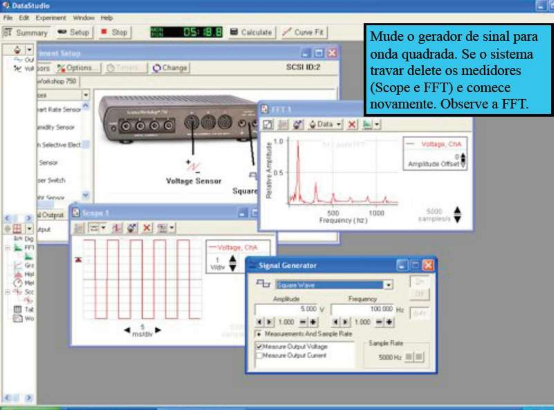
Mude o gerador de sinal para onda quadrada. Se o sistema travar delete os medidores (Scope e FFT) e comece novamente. Observe a FFT.
